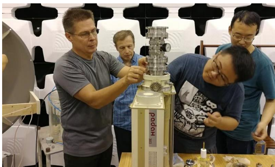
图 26 谢彦召教授课题组师生与 Sergey Shunaylov 博士等正在调试窄带高功率微波辐射系统
